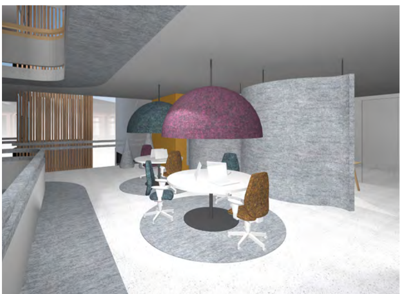
Bemanningsbyrå - Jobbkafé: Arbeidsbord, kontorstoler, og store filtkupler med integrerte belsningsarmaturer henger over bordene for arbeidslys og lyddemping.
